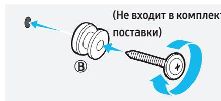
6. Установите **2 настенных кронштейна** в правильном направлении на нижней панели саундбара с помощью **2 винтов**.
