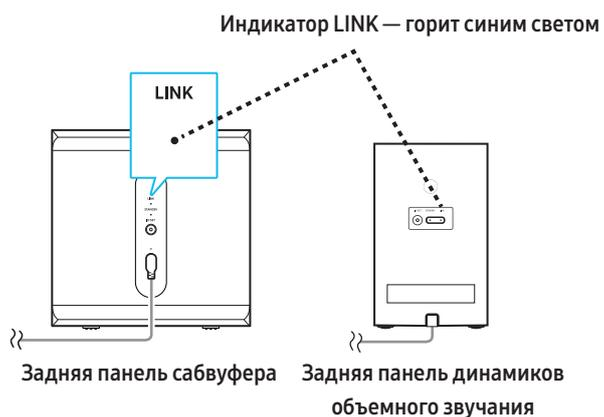
Если саундбар правильно подключен к сабвуферу и динамикам объемного звучания, светодиодный индикатор LINK перестанет мигать и загорится синим светом.
