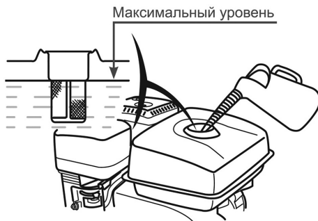
Рис. 13 Максимальный уровень топлива в топливном баке
