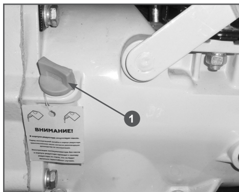
Рис. 14 Крышка-щуп маслозаливного отверстия коробки передач
