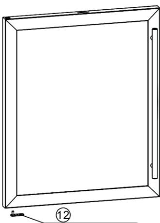
13). Совместите верхнее отверстие двери с осью верхней петли, выровняйте дверь с нижним кронштейном, и закрепите, закрутив два винта в нижний кронштейн и ось.
