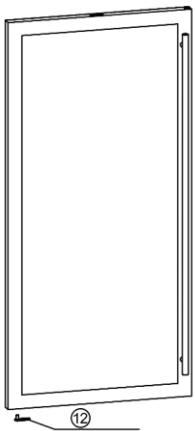
13). Совместите верхнее отверстие двери с осью верхней петли, выровняйте дверь с нижним кронштейном, и закрепите закрутив два винта в нижний кронштейн и ось.
