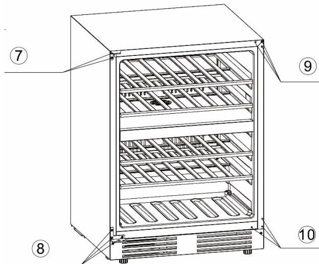
11). Поверните дверь на 180° и вставьте ось петли в нижнее отверстие двери.
