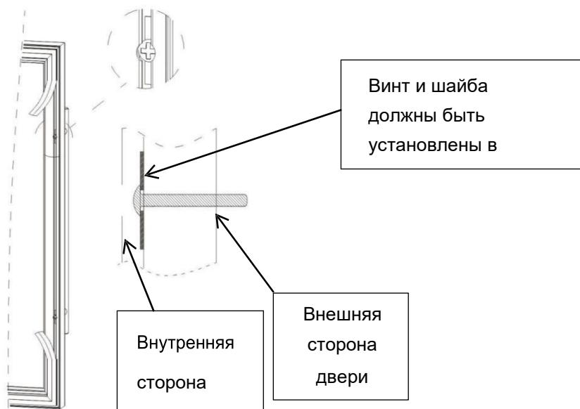
3. Совместите рукоятку с винтами и затяните винты. Ручка должна плотно прилегать к дверной раме (НЕ прикладывайте большое усилие при затяжке винтов, так как это может привести к повреждению узла рукоятки, поверхности двери либо стекла).
