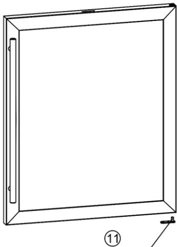
12). Поверните дверь на 180° и вставьте ось петли в нижнее отверстие двери.
