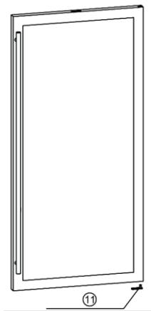
12). Поверните дверь на 180° и вставьте ось петли в нижнее отверстие двери.
