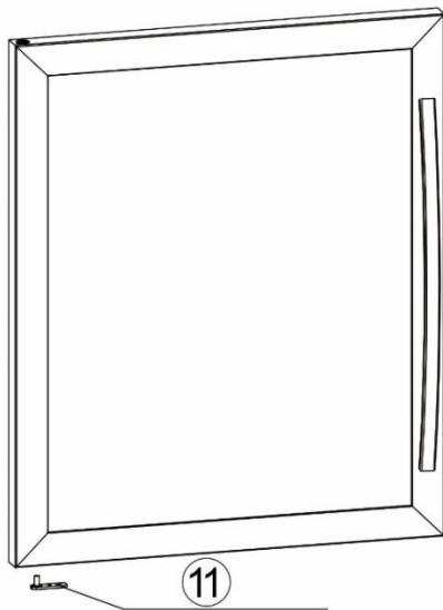
12). Совместите верхнее отверстие двери с осью верхней петли, выровняйте дверь с нижним кронштейном, и закрепите закрутив два винта в нижний кронштейн и ось.
