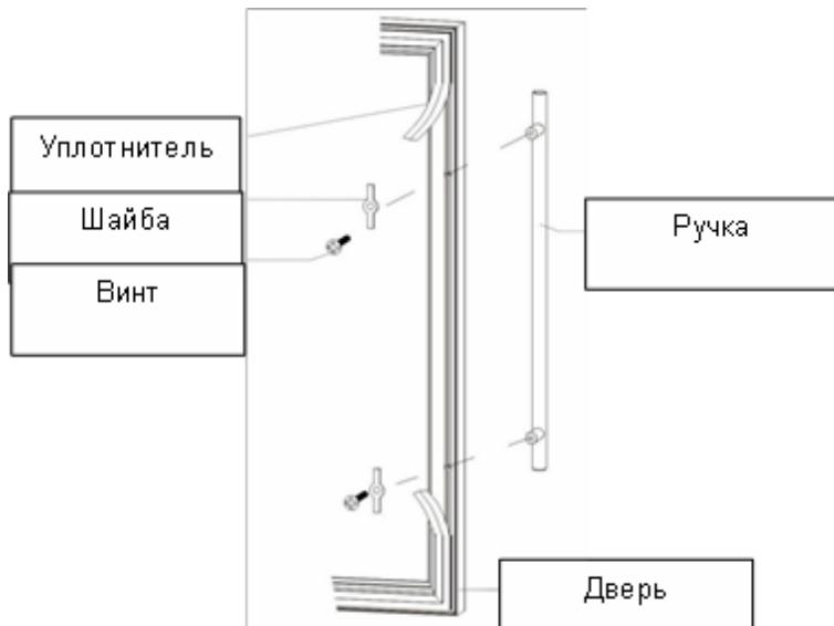
2. Установите шайбу и вкрутите винт в отверстие в раме двери, обратите внимание, что шайба должна находиться внутри гнезда и винты проходят через дверную раму.
