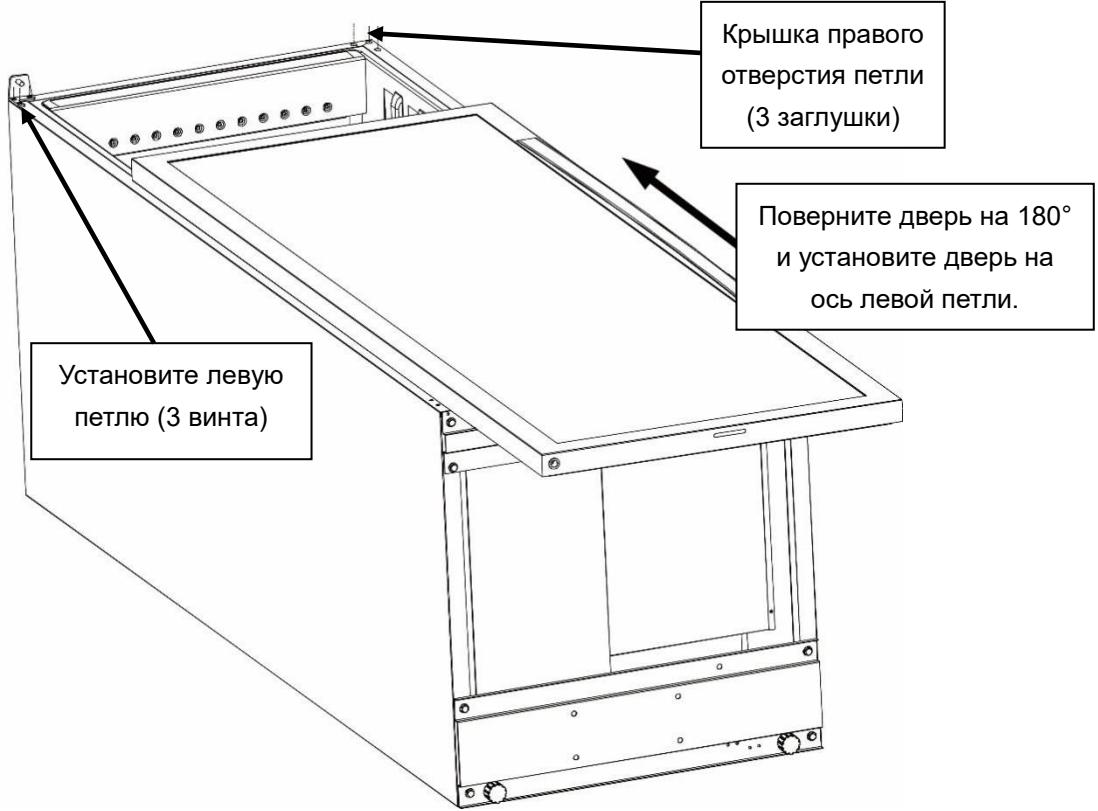
6. После того, как дверь вставлена в ось левой петли, выровняйте ее со шкафом и установите нижнюю петлю в левую нижнюю часть и установите опору двери в правую нижнюю часть.
