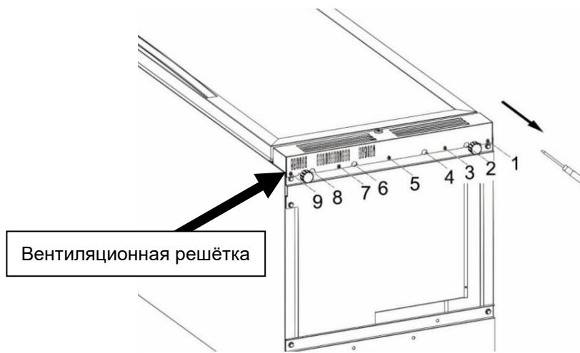
4. После снятия вентиляционной решётки надо открутить винты на опоре двери (2 винта) и 4 винта на нижней петле.
