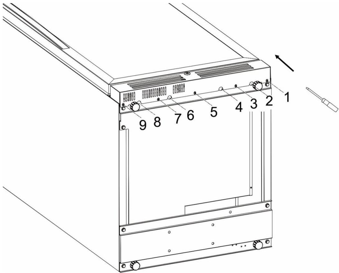
8. Закройте отверстие для замка в верхней части дверной рамы, чтобы закончить установку двери.
