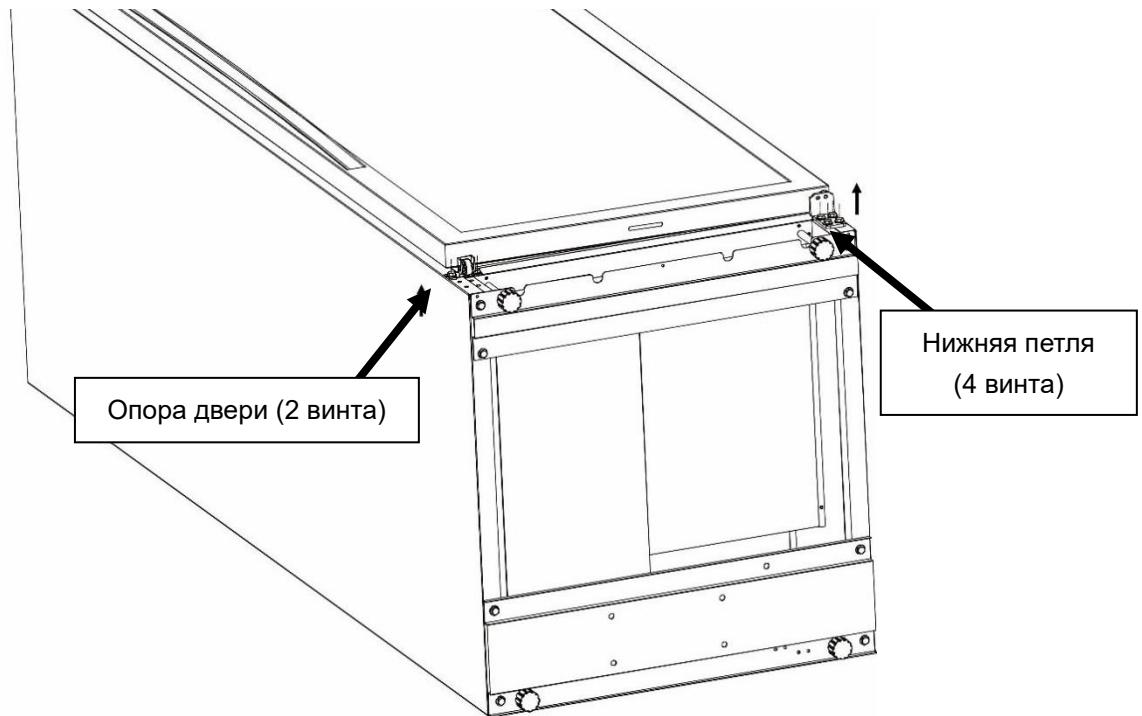
5. Сняв опору двери и нижнюю петлю, снимите дверь, положите дверь на мягкую поверхность, обращайтесь с ней осторожно, так как дверь очень тяжелая.
