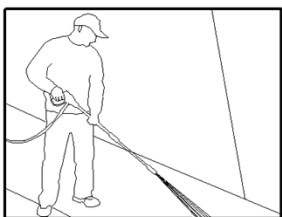
Рис. 6. Оптимальный угол относительно очищаемой поверхности
