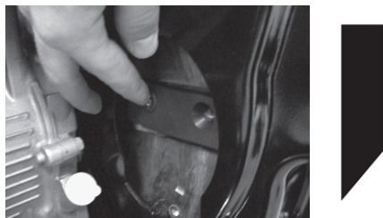
Рис. 23 Установка ножа измельчителя
