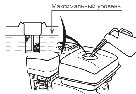
Рис. 8 Максимальный уровень топлива в топливном баке
