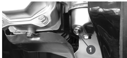
Рис. 16 Слив топлива из карбюратора 1. Болт сливного отверстия
