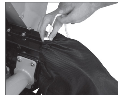
Рис. 4 Установка мешка для сбора продуктов измельчения
