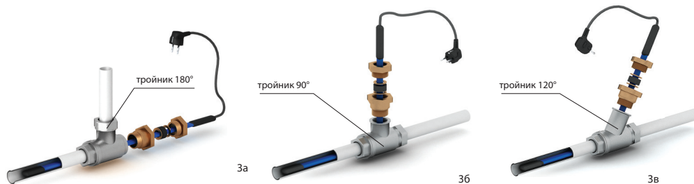
Рис.3. Схемы ввода нагревательной секции внутрь трубопровода: а - прямой ввод; б - ввод под углом 90°; в - ввод под углом 120°
