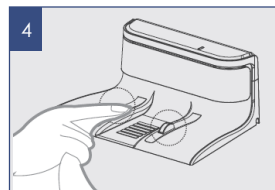
Очистка контактных клемм на зарядной базе
