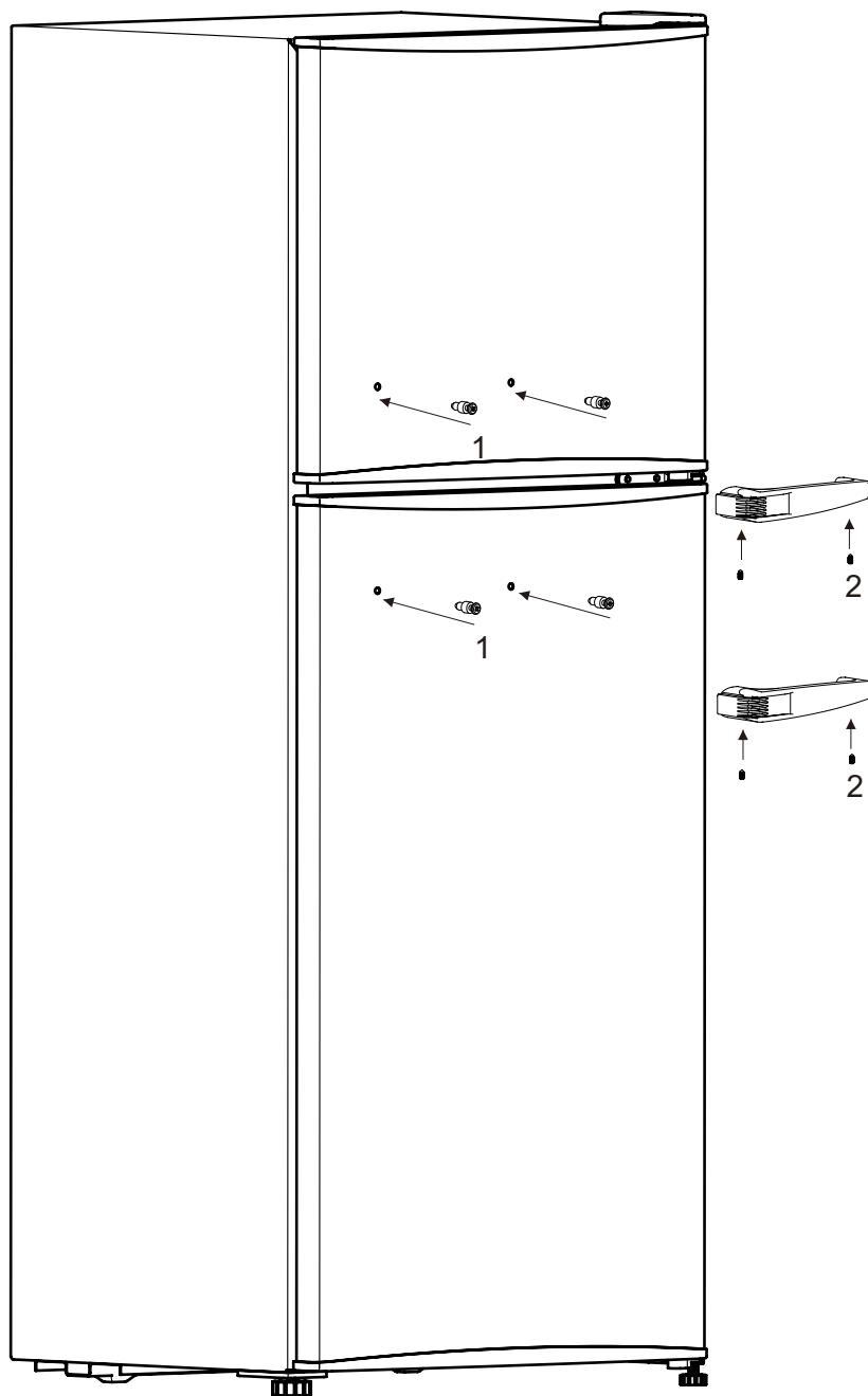
Как показано на рисунке, установите ручку в крепление для ручки двери и затяните винты с помощью шестигранного ключа .
