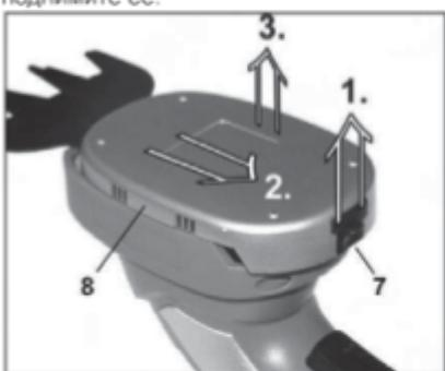
2. Снимите режущую головку (9/10).
