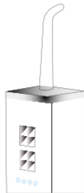
5. Для извлечения сопла нажмите на кнопку на корпусе прибора.
