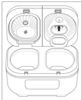
2. С небольшим усилием вставьте паровой клапан в гнездо.
