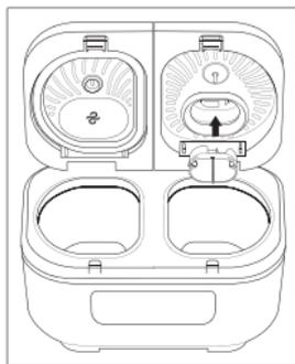
3. Установите уплотнительное кольцо во внутреннюю крышку, затем вставьте внутреннюю крышку, как показано на рисунке, и нажмите до щелчка.
