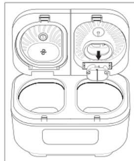
3. Снимите уплотнительное кольцо парового клапана с крышки, потянув его на себя.
