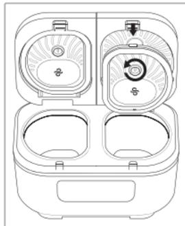
2. Снимите паровой клапан с крышки, потянув его на себя.
