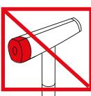
Выпускное отверстие, металлическое кольцо, насадки и зона, помеченная красным, могут сильно нагреваться в процессе использования. Дайте им остыть, прежде чем прикоснуться.
