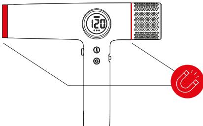
Удобный магнитный держатель-магнитные насадки можно быстро и легко прикрепить к передней части устройства
