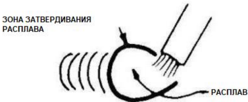
Рис.3 - Большинство новичков сваривают слишком быстро, что приводит к узкому и неровному шву.
