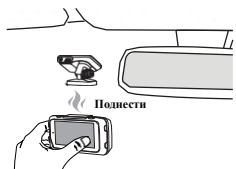
Для снятия устройства с магнитного держателя потяните его одной рукой на себя, а второй рукой придерживайте кронштейн во избежание его отклеивания от лобового стекла.
