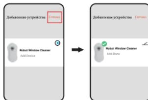
10. Нажмите "Robot Window Cleaner" (Робот-мойщик окон). Затем нажмите кнопку " ⏻ ", чтобы включить устройство
