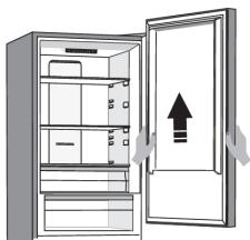
Приподнимите верхнюю дверцу и аккуратно снимите со среднего шарнира. Положите дверцу на ровную поверхность.
