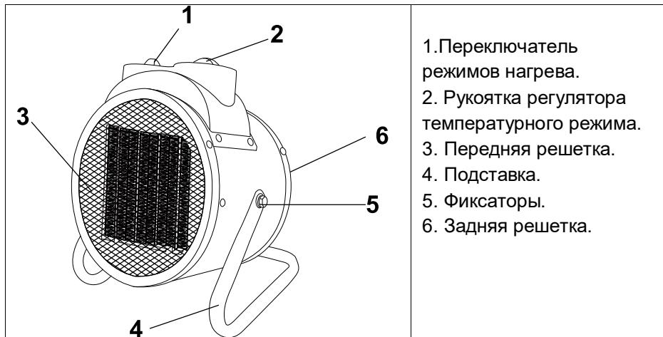
Тепловентиляторы электрические воздушные предназначены обогрева производственных, общественных, административных и бытовых помещений. Тепловентилятор устанавливается на полу. Подключается к сети однофазного переменного тока 220 В, 50 Гц.
