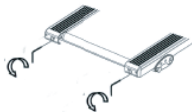
повернуть против часовой стрелки, что-бы ослабить натяжение бегового полотна
