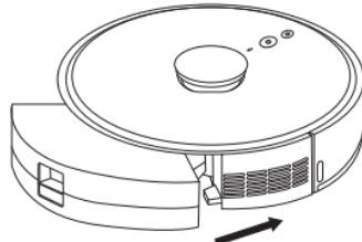
2. Включите прибор, нажав и удерживая примерно 3 сек. кнопку ⏹ на корпусе робота-пылесоса, чтобы перевести его в режим ожидания.
