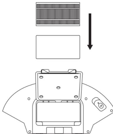
10. Закройте крышку контейнера и установите его в робот-пылесос.
