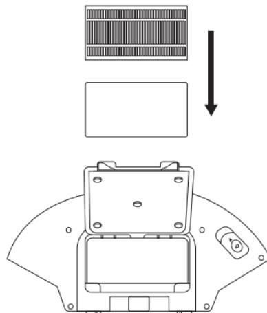
9. Закройте крышку контейнера и установите его в робот-пылесос.
