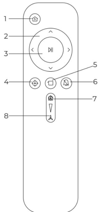
1. Кнопка «Домой» . Отправляет робот-пылесос на зарядную станцию
