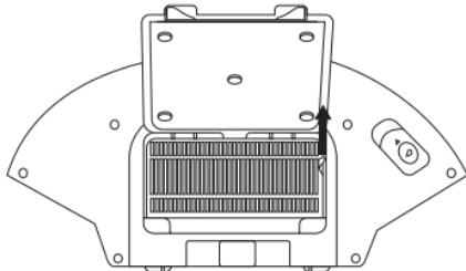
6. Извлеките фильтрующую губку и фильтр предварительной очистки. Промойте фильтрующую губку под проточной водой. Очистите HEPA-фильтр, фильтр предварительной очистки и комбинированный контейнер с помощью чистящей щетки.
