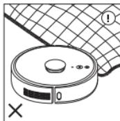
Помните, что робот-пылесос не заедет в пространство высотой меньше 10 см. Низкие диваны, тумбы и прочую мебель нужно сдвинуть или приподнять, чтобы робот-пылесос смог убрать это пространство.
