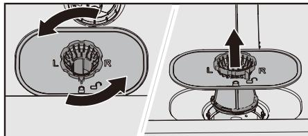
1. Поверните стопорное кольцо против часовой стрелки и поднимите фильтр вверх.
