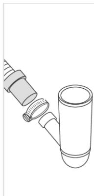
Сливной шланг можно удлинять не более чем на 3 м. При этом его общая длина должна составлять не более 4,5 м. Внутренний диаметр сочленений и патрубков не должен превышать 14 мм. Тем не менее при необходимости сливной шланг рекомендуется заменять шлангом без сочленений. Ни одна часть сливного шланга не должна располагаться на высоте более 950 мм над нижним краем машины.
