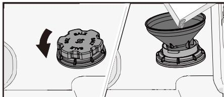
1. Снимите крышку отделения для соли, повернув ее против часовой стрелки.
