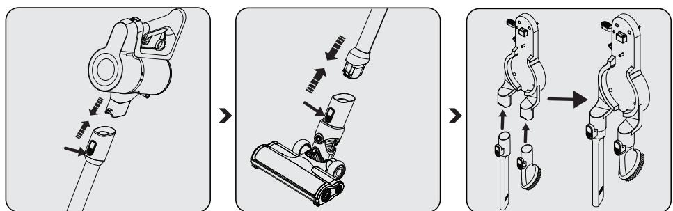
Надавите на трубу (10) в направлении стрелки к корпусу, нажав на кнопку разблокировки трубы (6).
