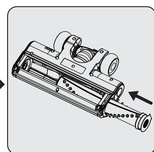
Снова зафиксируйте роликовую щетку на месте путем нажатия.
