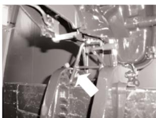
4) Придерживая заднюю часть верхнего кожуха рукой, полностью откиньте мотор кверху, пока рычаг автоматической блокировки не займет верхнее положение.
