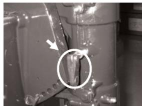
2) Затяните регулировочный винт рулевого трения, чтобы предотвратить поворот мотора.
