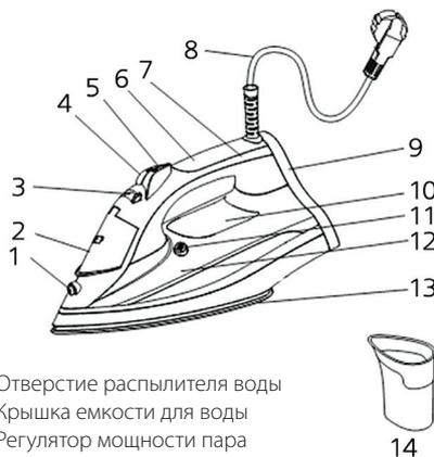
1. Отверстие распылителя воды
