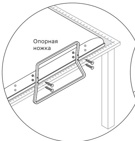
б. Если в комплекте две ножки, используйте отверстия по краям
