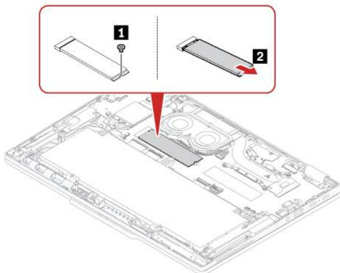
Шаг 2. Установите твердотельный диск M.2 в обратном порядке.
