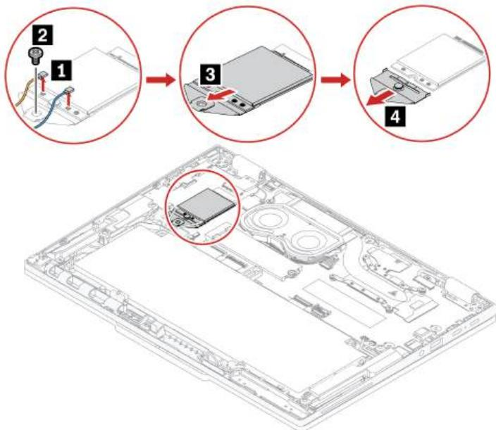
Шаг 2. Установите модуль беспроводной сети WAN и его крепежную скобу в обратном порядке.
