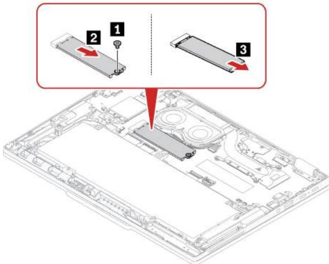
Шаг 2. Установите твердотельный диск M.2 и скобу твердотельного диска M.2 в обратном порядке.
