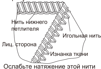
Нить нижнего петлителя перетянута на изнаночную сторону. Рис.2
