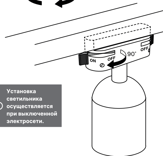
Шаг 3. Поместите коннектор светильника в шинпровод
