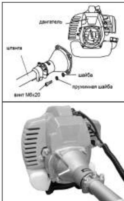
Рис. 5 Соединение двигателя и штанги
