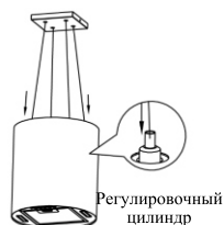
Затем прикрепите свободные концы подвесных тросов к вытяжке с помощью цилиндров.
