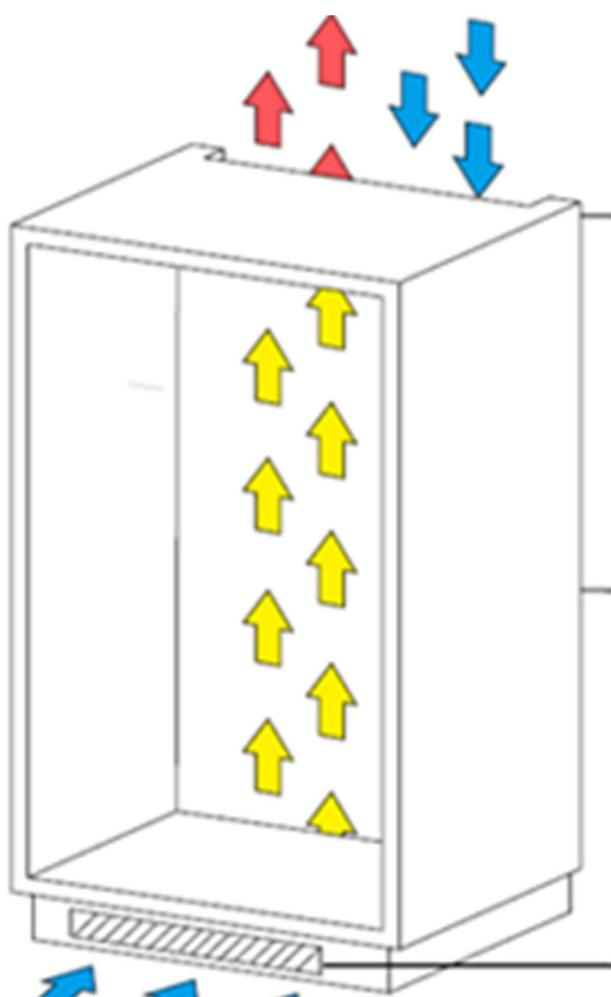
В задней, нижней части шкафа должен быть вентиляционный зазор, для поступления прохладного воздуха.
