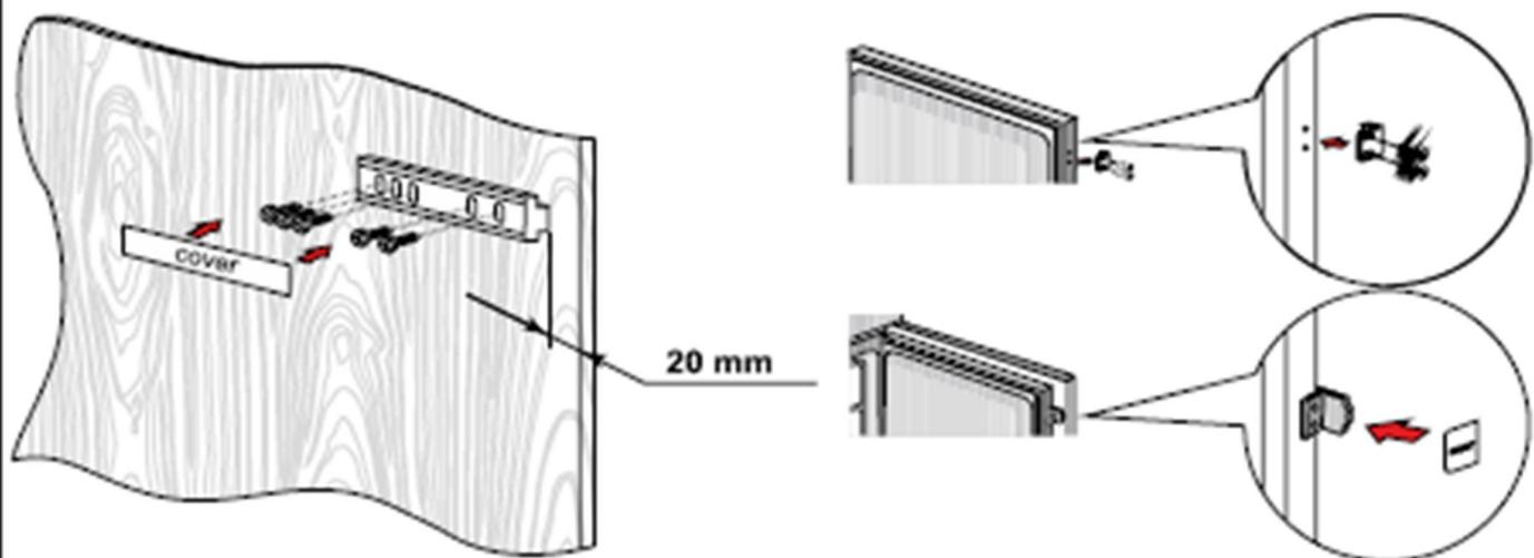
**7.** Установите крышку петли в следующем положении.
