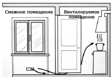
Рис. 3. Устройство вентиляции через смежное помещение
