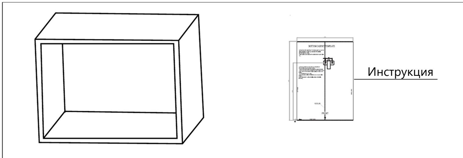
2. Вставьте микроволновую печь в нишу, держите прибор в горизонтальном положении, следите, чтобы расстояние до двух краев с обеих сторон было одинаковым. Вставьте винты (компл. 1) на верхнем ребре прибора и закрутите их в нишу.
