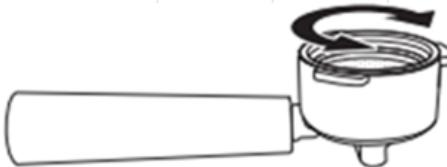
**Внимание:** Чтобы снять и очистить фильтр, поверните его влево или вправо, чтобы выровнять выемку фильтра с канавкой внутри рожка под давлением .
