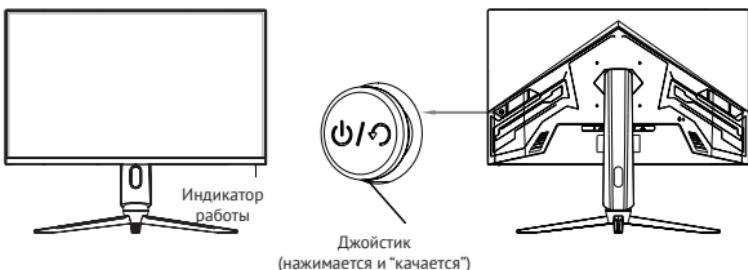
Когда монитор работает normally, индикатор горит синим цветом; когда он находится в состоянии энергосбережения без сигнала, индикатор горит красным цветом. В режиме ожидания мигает красный индикатор. В целях безопасности монитор следует отключать от сети, когда он не используется.
