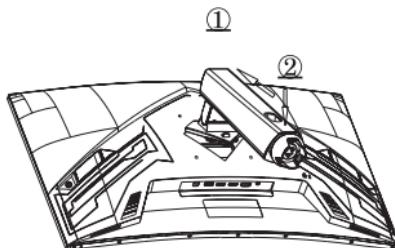
Установите опору основания от отверстие на задней части монитора под углом в направлении стрелки так, как показано на рисунке 1. Зашелкните опору основания, надавив на нее по часовой стрелке вниз (до звука защелкивания)
