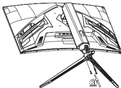
Вставьте основание в опору и закрепите с помощью 3-х комплектных винтов M4x16, как показано на рисунке 3.
