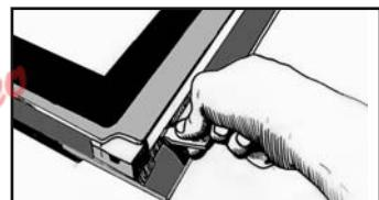
Поднимите как рычагом каркас, чтобы отщелкнуть каркас со стеклом.
