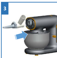
ЕЖұмыс блогының алмалы корпусын оң жаққа сәл еңкейтіп, корпустағы ұяшыққа кіргізіңіз
