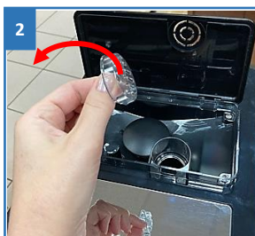
Откройте крышку отсека для зерен
