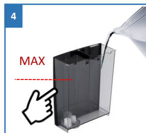
Резервуарды суға толтырыңыз ("MAX" белігісінен асырмаңыз)
