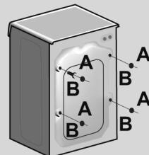
● Закройте **2** или **4** отверстия заглушками, которые находятся в конверте с инструкцией.
