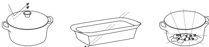
Под воздействием микроволн молекулы в продуктах начинают быстро двигаться, создавая молекулярное трение, которое и приводит к нагреву продукта.
