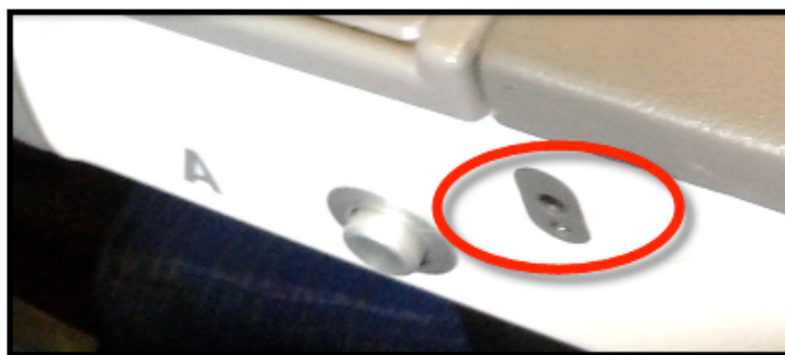
Рисунок 1.9 – Разъемы входа сиденья самолета (в подлокотнике)
