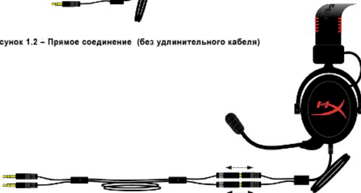
Рисунок 1.3 – Прямое соединение (с двухметровым удлинительным кабелем)
