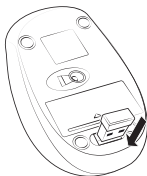
Рис. 6. Установка ресивера в корпус мыши
