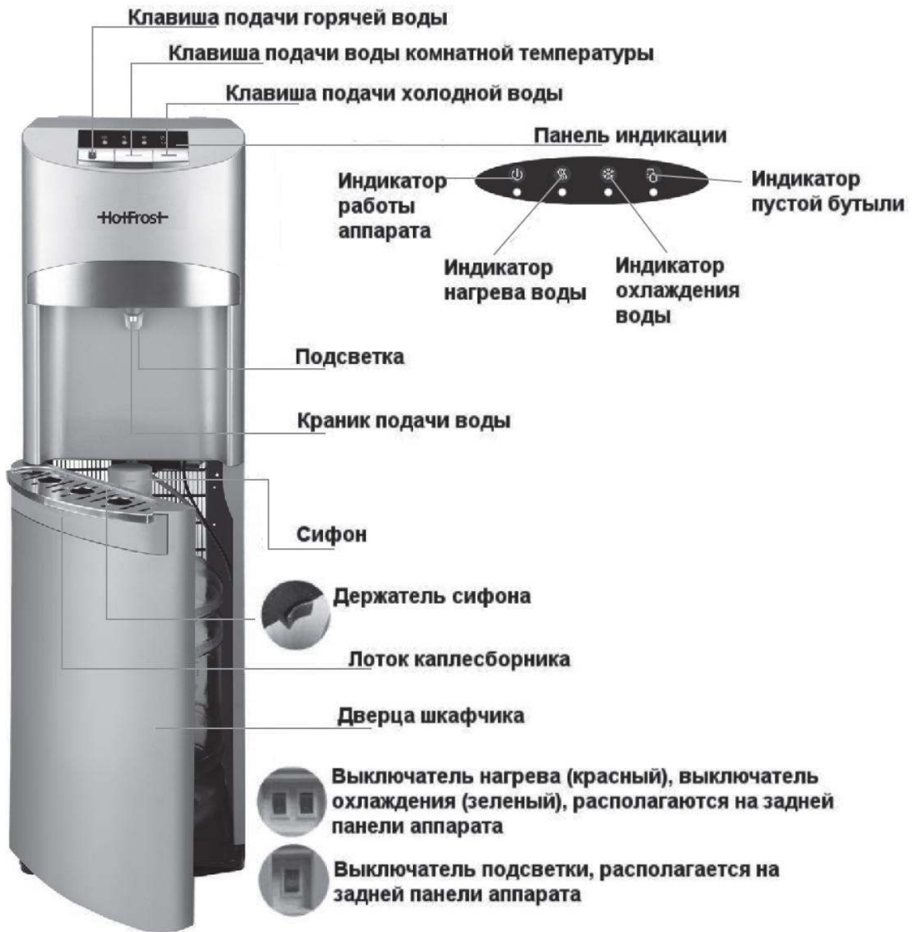
Рис.1 (б) Схема аппарата 35А (S,N)
