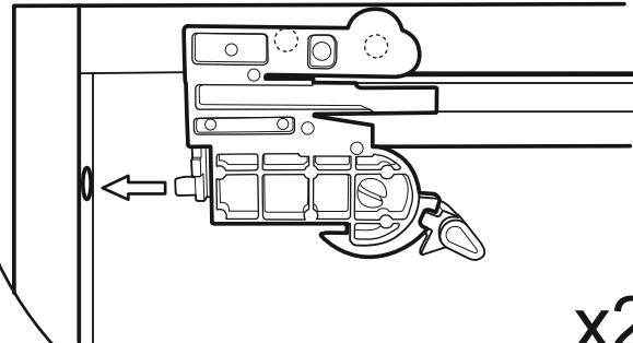
нажать на направляющие и выдвинуть их в максимальное положение.
