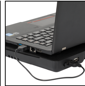
Verbinden Sie das USB-Kabel an den USB-Ausgang des kühlenden Ständers
