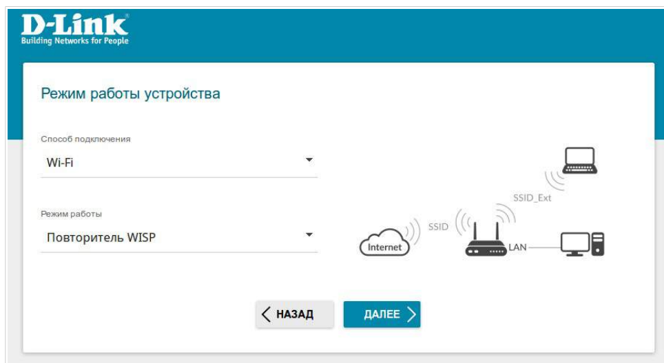
Рисунок 27. Выбор режима работы устройства. Режим Повторитель WISP .
