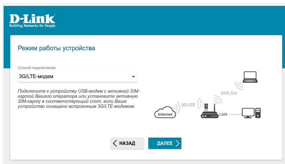
Рисунок 26. Выбор режима работы устройства. Режим 3G/LTE-модем .
