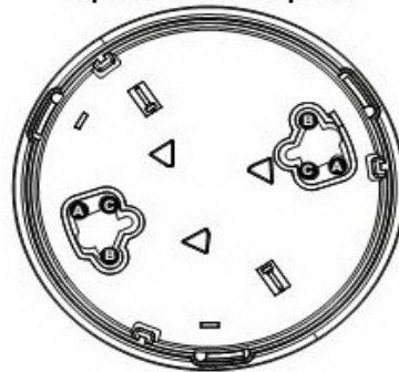
Варианты расположения крепёжных отверстий
