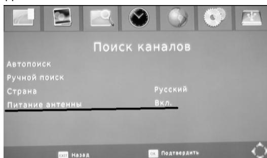
телевизора или ресивера. Для работы встроенного усилителя необходимо внешнее питание +5В, которое подводится по коаксиальному проводу. Включите питание в меню приемного устройства (см. инструкцию по эксплуатации приемного устройства).
