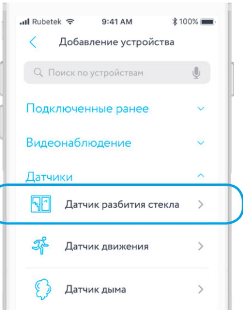
3. Переведите датчик в режим добавления нажатием кнопки «TEST», расположенной под задней крышкой устройства, и следуйте подсказкам в приложении:
